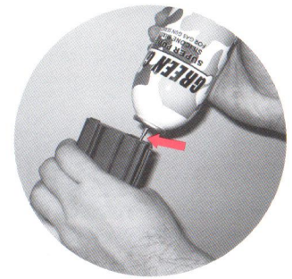
將瓦斯由底版注入孔灌入 Fill gas from bottom of magazine. ※限使用12kg 瓦斯 (R22/Green Gas)
